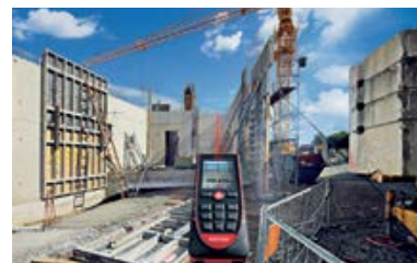
D510 - Horizontaldistanz mit Schrägmessung und Geräteneigung
