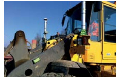
Zwei GNSS-Antennen auf dem Radlader
