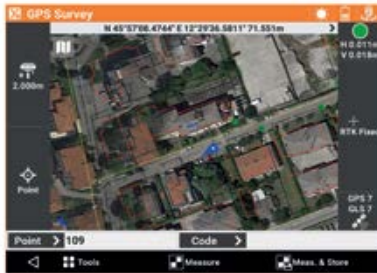
Einblendung eines Luftbildes über den Plan
