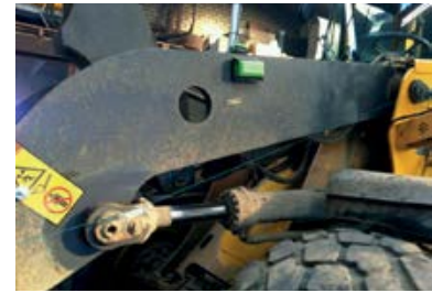
Installierter Sensor am Radlader
