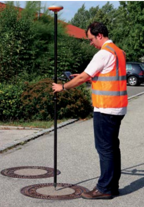
Aufnahme eines Kanaldeckels in der Gemeinde mit Übertragung der Daten ins GIS-System oder per Direktmessung in die Esri ArcGIS Software
