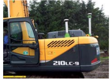
Zwei DigPilot-Antennen verbunden mit der GNSS-Box im Bagger liefern dem System Position, Höhe und Peilung des Baggers
