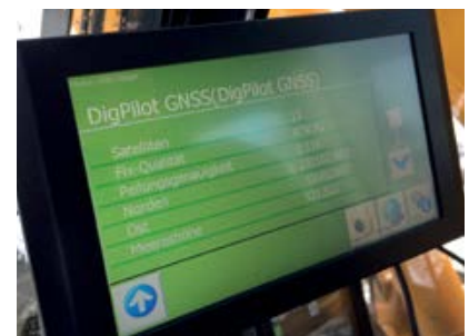
Kontrolle des Systems über den Bildschirm im Führerhaus
