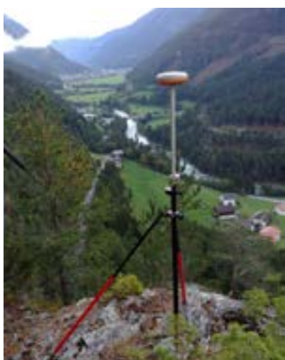
Hochpräzise Messungen von Passpunkten durch das österreichische Bundesamt für Eich- und Vermessungswesen BEV
