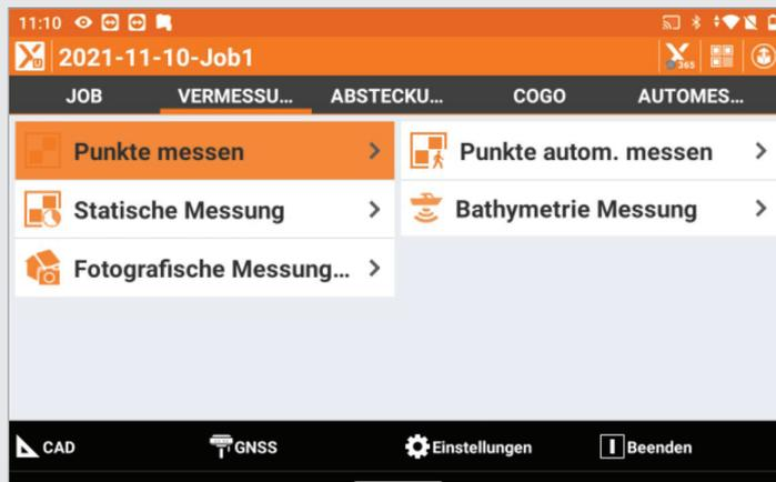
11. Gehen Sie bei der Messung sicher, dass der Status der Antenne „RTK Fixed“ ist. Tippen Sie unten links auf den Pfeil, um zurück zu gelangen, wenn Sie mit der Messung fertig sind.
