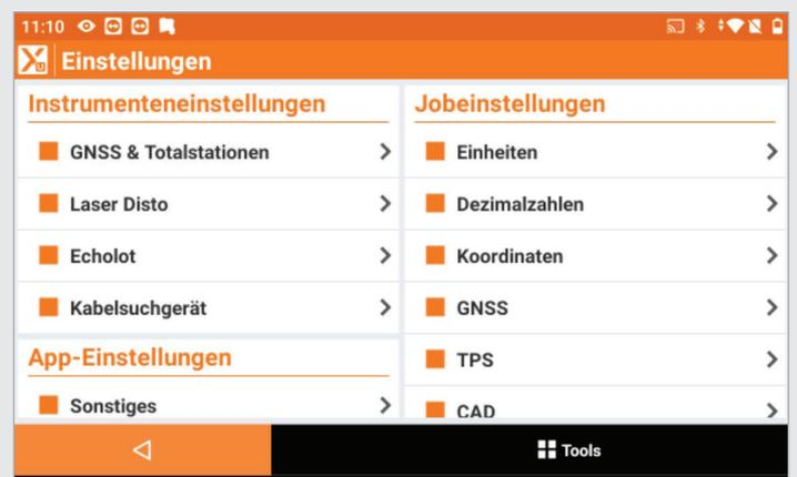
7. Tippen Sie nun unten im Menü auf „GNSS“, um sich per Bluetooth mit der Antenne zu verbinden.
