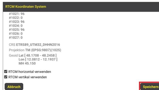
6. Das Feld „Koordinatensystem“ wird automatisch ausgewählt. Sie müssen nur noch im Feld „Geoid“ das gerade erstellte „RTCM Geoid Height“ auswählen.
