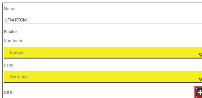
5. Die Software erstellt dann mithilfe der RTCM Nachrichten ein Koordinatensystem mit den richtigen Parametern. Tippen Sie auf Speichern damit das Koordinatensystem auch gesichert wird. Mit dem Zurückbutton des Tablets gelangen Sie dann wieder ein Menü zurück.
