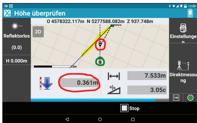
15.) Nun sehen Sie den Höhenunterschied zur geplanten Höhe an der aktuellen Position (rot eingekreist). Wie Sie die Wand richten müssen, sehen Sie am besten in der Grafik. Dort sind die Totalstation (grün eingekreist), die aktuelle Position der Wand (rot eingekreist), sowie die geplante Wand (gelb markiert) eingezeichnet. Im jetzigen Beispiel müsste die Wand noch senkrechter gestellt werden. Beachten Sie unbedingt, dass die Höhenangabe nicht der Lageverschiebung entspricht.
