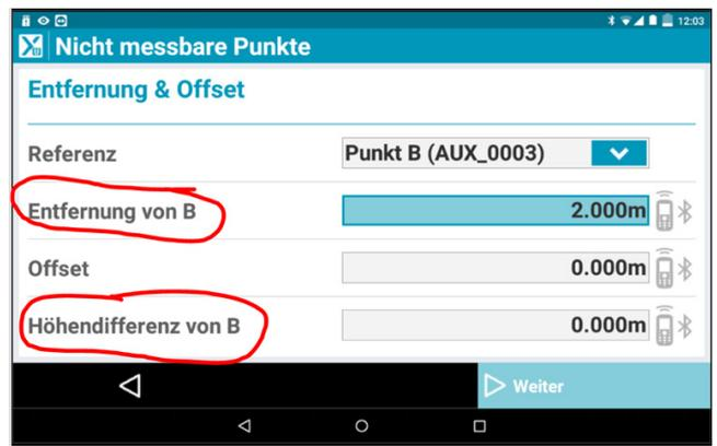
8.) Nun soll die Gerade von Punkt B (unserem zweiten Messpunkt) zum Objekt verlängert werden, geben Sie bei „Entfernung von B“ das Maß vom zweiten Messpunkt zum Objekt an. Ebenso besteht die Möglichkeit den Höhenunterschied von Punkt B zum Zielpunkt einzugeben. Klicken Sie anschließend auf „Weiter“.
